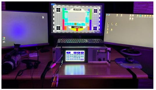
Prime prove di trasmissione e ricezione via RF sulle bande dei 6 mt, 2 mt, 70 cm, 13 cm e 23 cm. Collegato via rete LAN è possibile trasmettere e ricevere flussi video TS verso OBS, VLC, Adalm Pluto o instradarli via Internet (anche in WiFi sfruttando il modulo del Raspberry che può essere anche spento da terminale SSH per evitare eventuali interferenze con le trasmissioni in banda 13 Cm).
