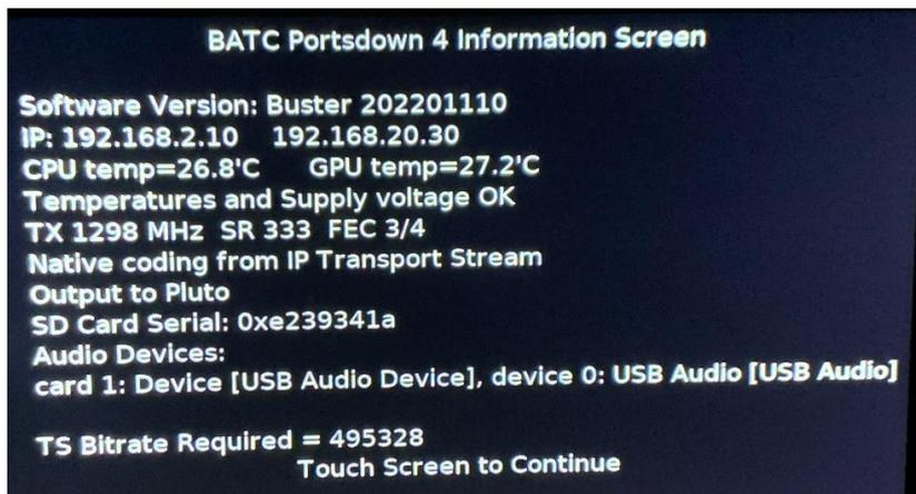
Quindi passare in Obs dal menu "Dirette" al menu "Uscita" e impostare la codifica QuickSync H.264 e per SR 333Ks "Rilascia l'uscita" a 1280x720 (px). Impostare gli altri parametri come da figura e per "Velocità in bit" io ho trovato l'ideale a 290 Kbps ma potete riferirvi alla voce del menu di Portsdwn "TS Bitrate Required= xxxx" e fare dei test .
